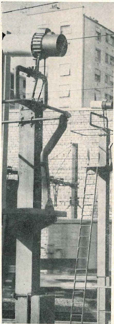
Fig. 3 - Stazione di Digione-Città: (a sinistra) Ad una estremità dei marciapiedi 4 e 5 sono poste due camere televisive sotto custodie stagne e munite di parasole. Esse possono controllare fino quattro convogli, due per marciapiede. Le corrispondenti immagini, commutabili a volontà, appaiono sul televisore posto dentro l'ufficio traffico, all'estremità opposta della stazione.
