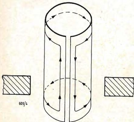
Fig. 4 - Supporto della bobina mobile, con l'indicazione del circuito delle linee di campo elettrico
