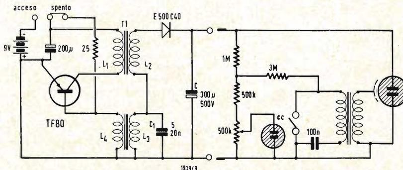
Fig. 5 - In questo alimentatore la corrente di reazione è funzione della potenza richiesta.
