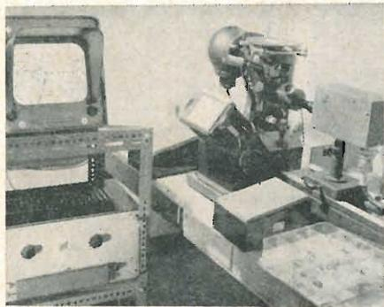
Fig. 4 - Telemicroscopia: a destra, l'apparecchiatura da ripresa con microscopio e camera accoppiate. A sinistra, uno dei televisori che riproduce l'immagine del soggetto analizzato.
