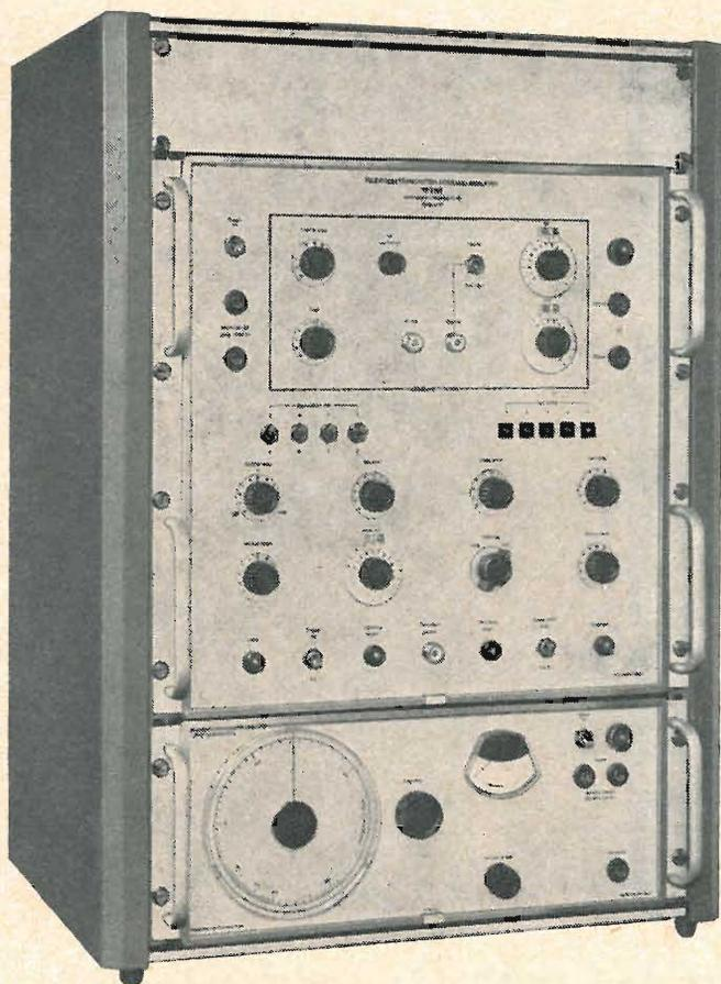
L'analizzatore TF 2360 e il convertitore TM 6936 funzionano sulle bande televisive 1, 3, 4 e 5 (32-88 MHz, 172-228 MHz, e 470-960 MHz.)
