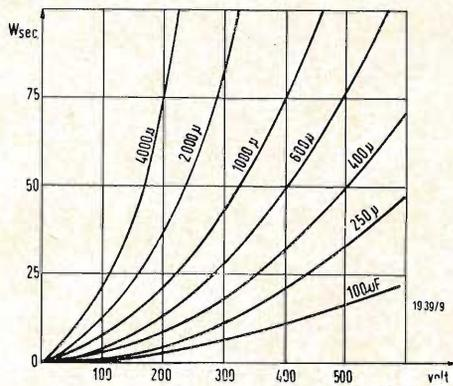
Fig. 2 - Energia immagazzinata in un condensatore, in funzione della tensione, per diversi valori della capacità.
