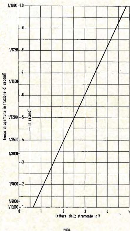
Fig. 3. Diagramma per la determinazione dei tempi di apertura. La virgola va spostata fino a farla corrispondere alla posizione di  $S_2$ .
