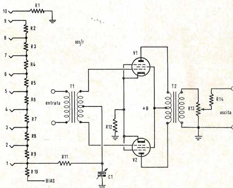
Fig. 1 - Schema di un amplificatore con il gruppo di controllo.
