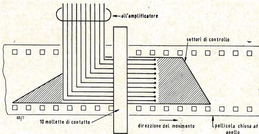
Fig. 2 - Disposizione dei settori metallici di controllo e delle mollette di contatto.
