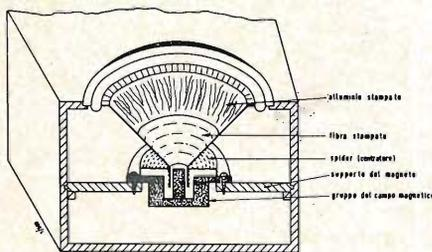
Fig. 2 - Il tweeter a bulbo emisferico (a destra), e il complesso centratore bobina mobile del woofer. Si noti il supporto metallico.
