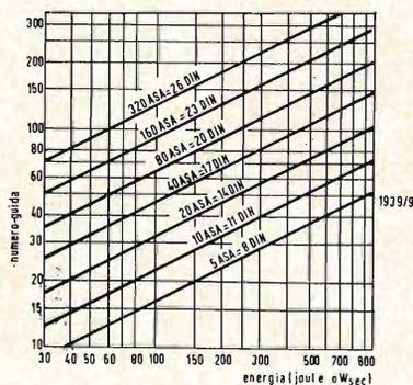
Fig. 1 - Numeri guida che si possono ottenere, con un riflettore di qualità corrente, in funzione dell'energia di scarica e dell'indice di posa (sensibilità).
