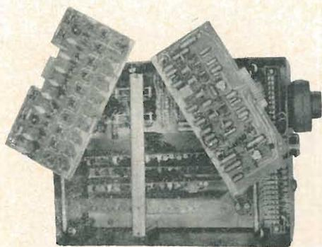
Fig. 6 - Pannello di comando transistorizzato, a piastrine estraibili per camera televisiva industriale.
