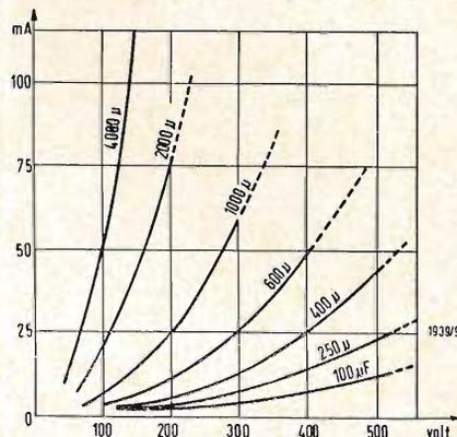
Fig. 3 - Abaco per la determinazione della corrente residua in un condensatore elettrolitico, che non abbia lavorato per alcune settimane, in funzione della tensione nominale del condensatore stesso.
