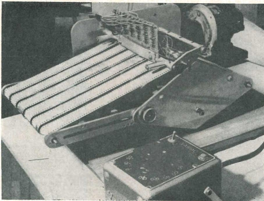
Fig. 7 Hamograf a sei tracce. La velocità del motore di trascinamento è controllata tramite un variac.
