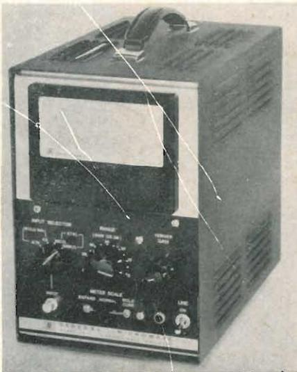
La GENERAL MICROWAVE Co. costruisce un misuratore amplificatore di onda stazionaria con alcune interessanti caratteristiche, destinato ad essere impiegato con linee fessurate o per misure di attenuazione. Il modello 35<sup>1</sup> ha quattro scale per VSWR e incorpora un circuito che protegge il bolometro da eventuali sovraccarichi.
