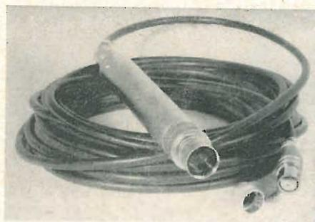
Fig. 5 - Camera cilindrica (diametro 52 mm, lunghezza 380 mm.) con il suo cavo di collegamento al pannello di comando.
