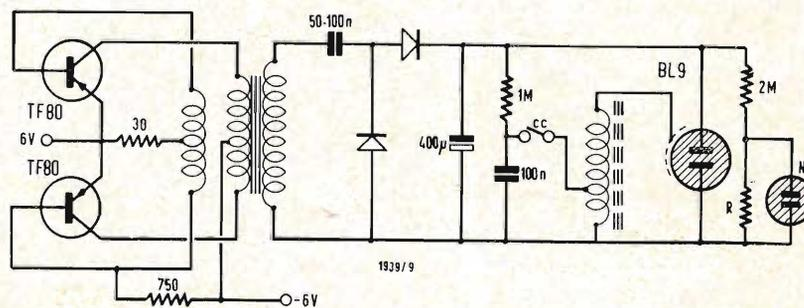
Fig. 4 - Alimentazione a convertitore simmetrico :è particolarmente facile da realizzare.
