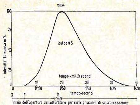
Fig. 1 - Intensità luminosa di un flash in funzione del tempo. Il valore massimo per il bulbo M5 si ha ad 1/50 di secondo dall'istante di azionamento dell'otturatore.
