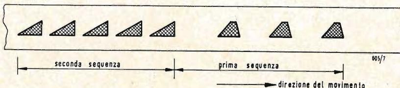
Fig. 5 - La spaziatura, dei settori metallici controlla l'andamento ritmico di un certo segnale.
