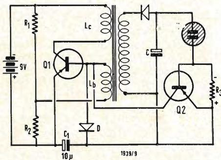
Fig. 6 - Schema di principio di un circuito di regolazione automatica.
