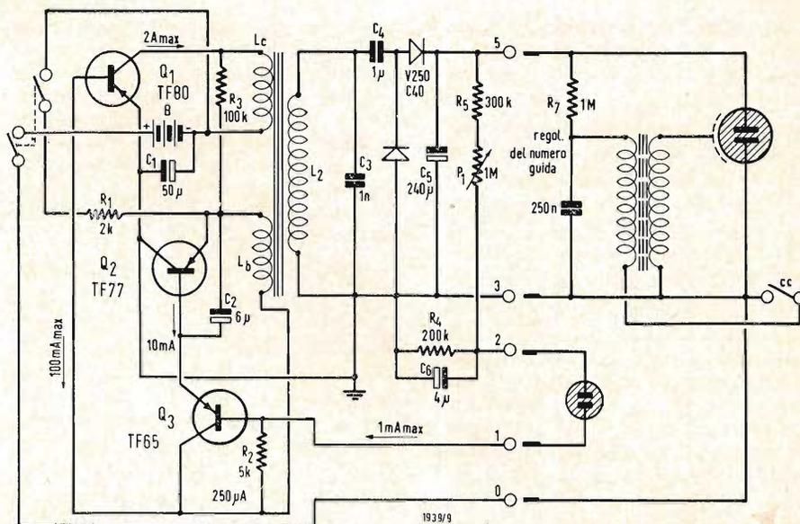
Fig. 8 - In questo circuito l'accensione della lampada al neon provoca il blocco simultaneo dei tre transistori.
