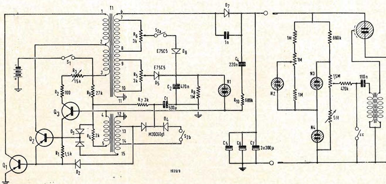
Fig. 9 - Comandando lo stadio di conversione con un oscillatore separato si può ottenere un rendimento particolarmente elevato.
