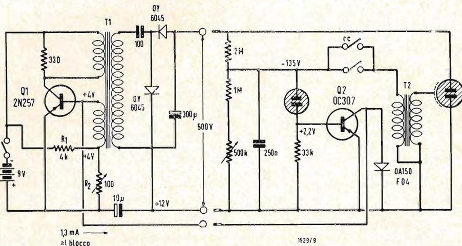
Fig. 7 - Schema completo dell'alimentatore basato sullo schema della fig. 6.
