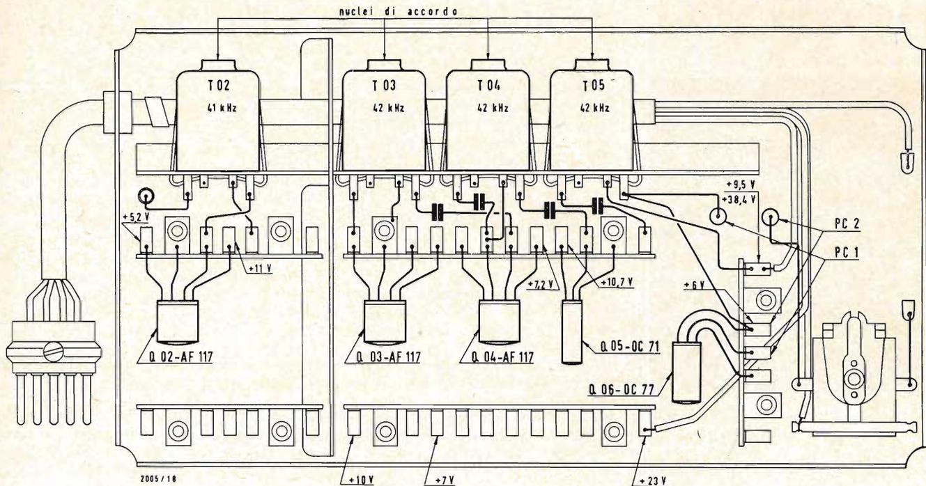
piano di montaggio e punti di controllo tensione ricevitore comando a distanza
